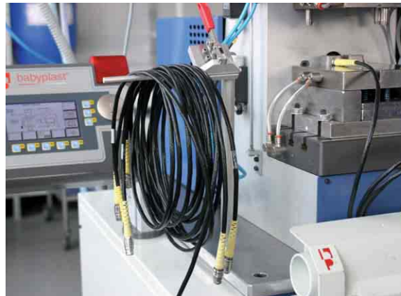
Cable overmold technology Umspritzen für Kabelzug- entlastungen
