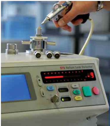
Vacuumtest with leakdetector Vakuumtest mit Leakdetektor
